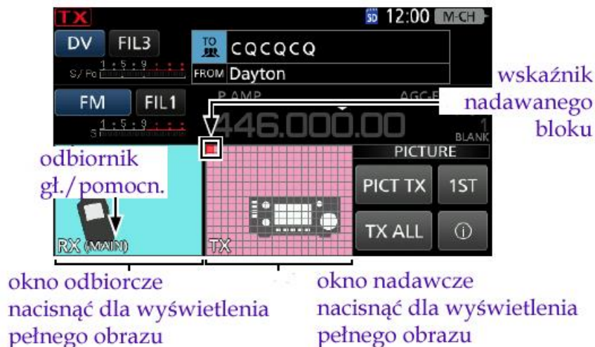
Rys. 2.5.2.1. Ekran w trybie obrazowym. W przypadku odbioru obrazów przez oba odbiorniki wyświetlany jest tylko obraz pochodzący z odbiornika głównego. Zapisywane są oba obrazy
