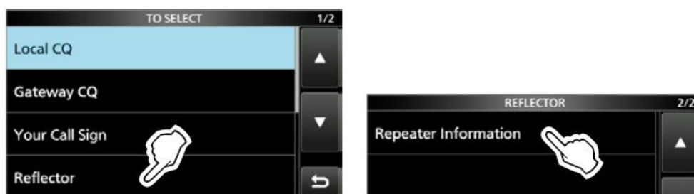
Rys 5.2.27 i 5.2.28. Wywołanie informacji od przemiennika – w polu UR umieszczana jest litera I na ósmej pozycji
